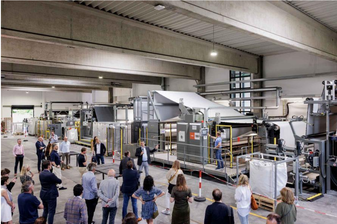
Neuartige Beschichtungsanlage, deren Prozess kein Gas und Wasser benötigt und bis zu 95% weniger Energie benötigt als herkömmliche Produktionsmethoden Foto: Simon Wegener
